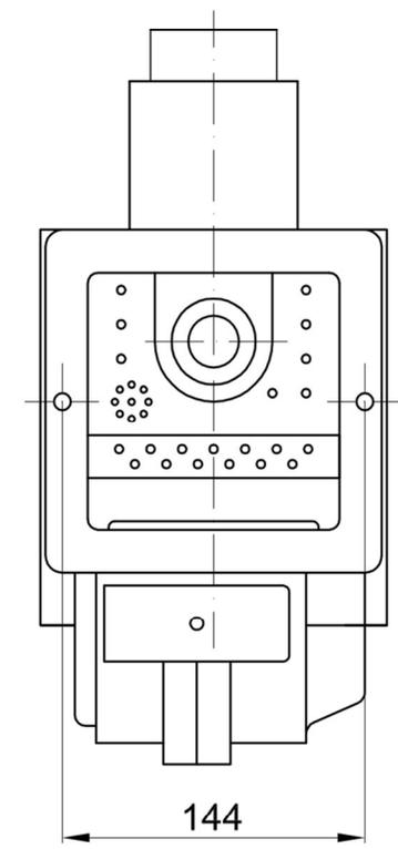
Abmessungen der Befestigungslöcher
